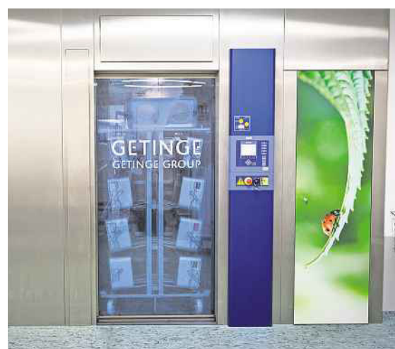
Arbeitet für Vier: Das neue Reinigungs- und Desinfektionsgerät desinfiziert 240 OP-Siebe am Tag. Fotos: Stefan Straube
