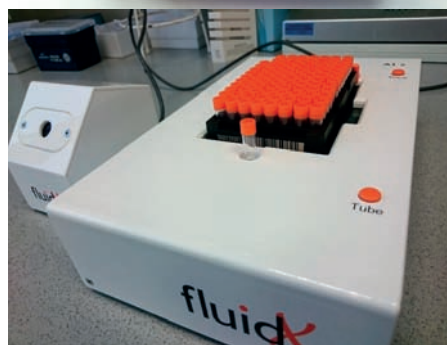
Abb 1.: Neues Röhrchenformat mit 2D-Barcode (oben) und dazugehörigen Scannern (unten)
