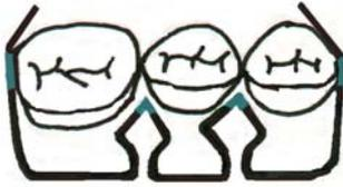
Abb. 27: An den grün markierten Abschnitten muss der Draht anliegen.
