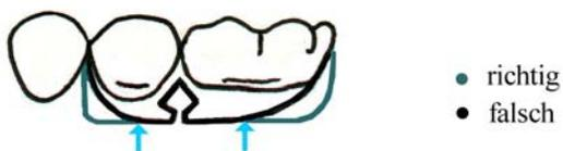
Abb. 34: Ab den mit Pfeilen gekennzeichneten Teilen der Klammerschenkel muß korrigiert werden.
