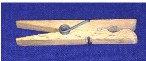
Abb. 38 a): Klammer mit kurzem Federarm
