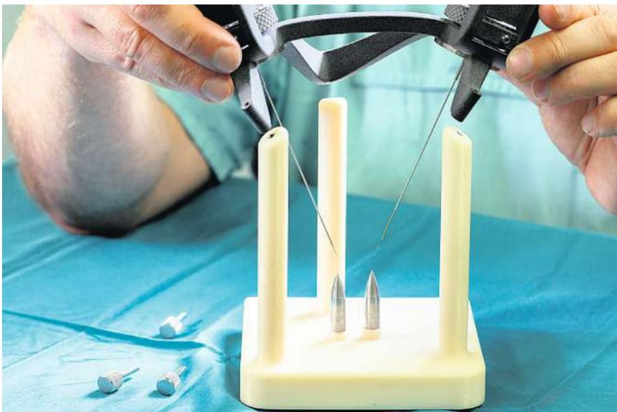
Innovativ sind die mittels 3D-Druck gefertigten individualisierten Stereotaxie-Systeme für zehntelmillimeter genaue Eingriffe am Gehirn. Erste Anwendungen in der Praxis sind in den kommenden Monaten geplant.
